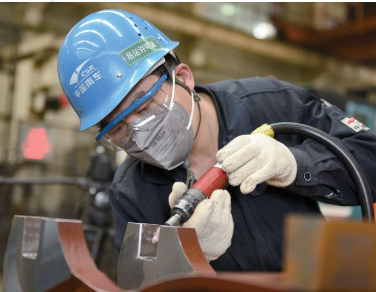
定位臂作为转向架上构架与车轮之间的接触部位，相当于人的“脚踝”。高速动车组在运行时速达200多公里的情况下，定位臂的接触面要承受相当于二三十吨的冲击力，定位臂和轮对节点必须有75%以上的
